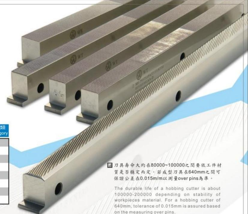
刀具壽命大約在80000~100000之間要依工件材質是否穩定而定。若成型刀具在640mm之間可保證公差在0.015mm以測量over pins為準。
